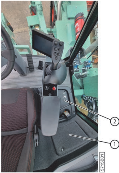
Fig. 32: Armoires électriques dans la cabine
