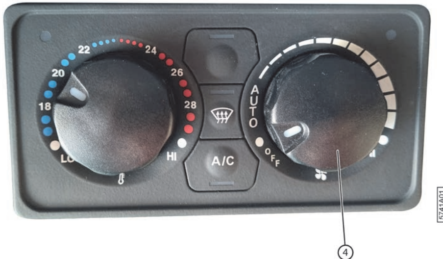
Fig. 95: Éteindre la climatisation
