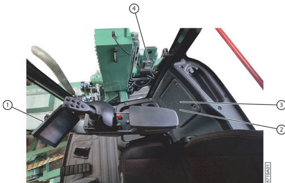
Fig. 34: Emplacement des contrôleurs
