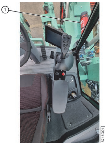
Fig. 38: Localisation de l'extincteur
