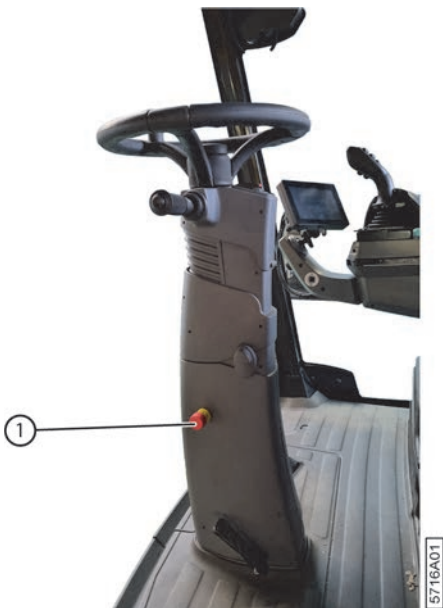
Fig. 48: Emplacement de l'arrêt d'urgence
