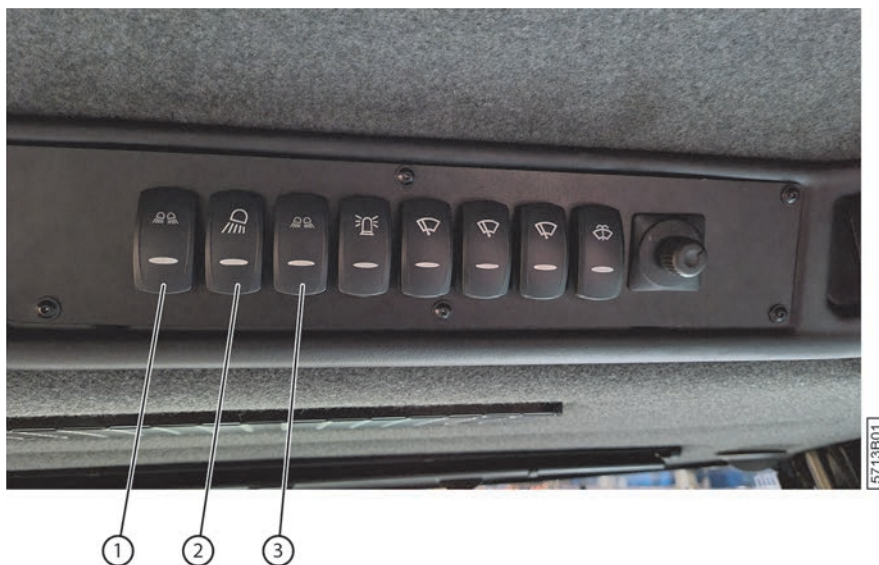
Fig. 67: Boutons de commande dans la cabine
