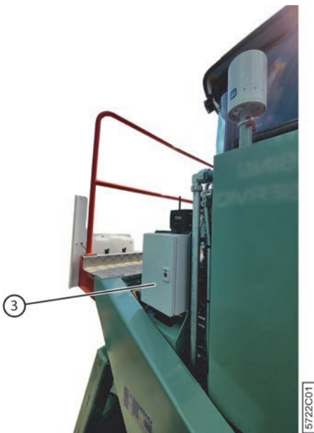
Fig. 33: Armoire électrique sur la machine (uniquement pour le moteur DEUTZ)
