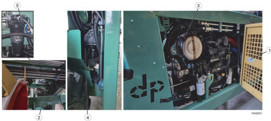
Fig. 124: Position des éléments de l'air conditionné
