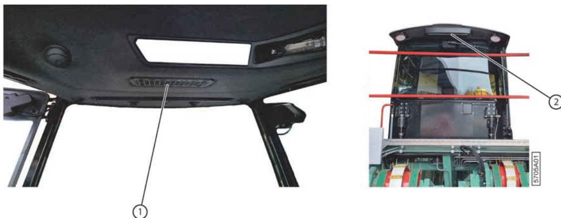
Fig. 153: Filtres à air de la cabine
